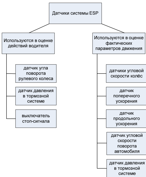
Рисунок 1 – Датчики комплексной системы стабилизации курсовой устойчивости
